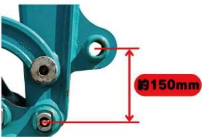
アームの先端から 約150mmのところで溶接します
